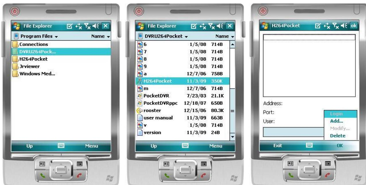
應用軟體提供遠端連線DVR的資料維護、單頻道畫面顯示、警報通知…等功能。進入應用軟體後，按下「OK」將出現操作項目，例如：遠端連線DVR的資料新增、修改、刪除、連線。說明請見以下表格。
