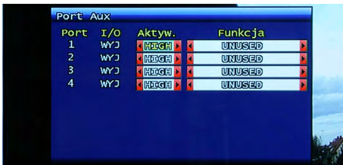
Rys. 3-37 Okno ustawień portu AUX
