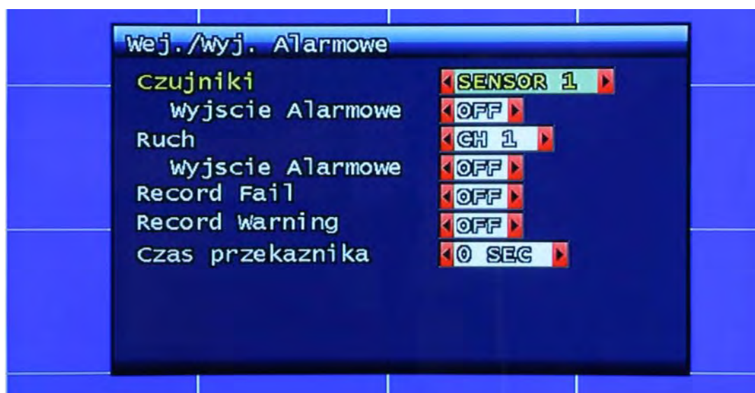
Rys. 3-14 Okno ustawień alarmów
